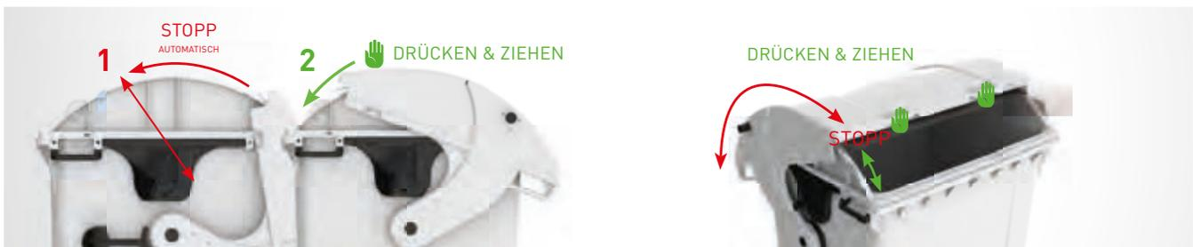
Um den Deckel vollständig zu schließen, ist es erforderlich, die Druckknöpfe zueinander zu betätigen und dabei den Deckel nach vorne zu ziehen. Diese sind an der vorderen Deckelkante angebracht und können bequem mit dem Daumen betätigt werden, während die Griffe gleichzeitig umfasst werden können. Die Druckknöpfe bewirken, dass die Kindersicherungswelle nach oben geschwenkt wird und kein Hindernis mehr hat und der Deckel vollständig geschlossen werden kann.
