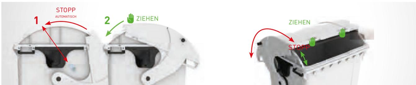
Zusätzliche Anbauteile an beiden Behälterseiten verhindern, dass der Runddeckel automatisch durch das Eigengewicht schließt. Dazu rastet die flexible Schenkelfeder in einem Halteblech ein. Der Deckel schließt nur bis zur Öffnungsposition und lässt einen Spalt von min. 181 mm offen stehen. Erst wenn der Deckel manuell zugezogen wird, schließt er sich vollständig.
